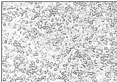
Ультра мелкозернистая структура Зернистость 0 - 0,5 микрон. Finegrain-hardmetal structure Ultra-micro-grain, Grain size 0-0.5 micron. Grain fin-métal dur- structure du grain Grain ultra fin, taille du grain 0-0.5µm.
