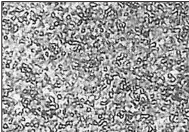
Feinstkorn-Hartmetall-Kornstruktur Ultra-Micro-Grain, Korngrößen 0–0,5 µm
